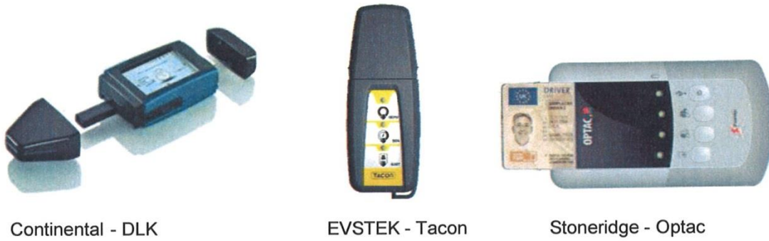
Şekil-13: Çeşitli dijital takograf veri indirme cihazları
