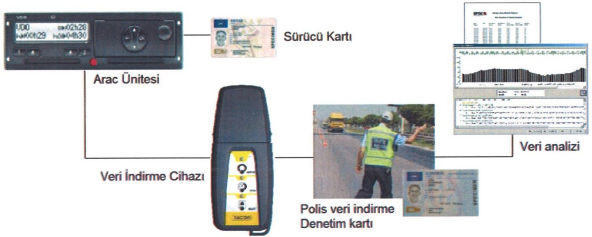
Şekil-12: Dijital takograflardan veri indirme ve analiz süreci
